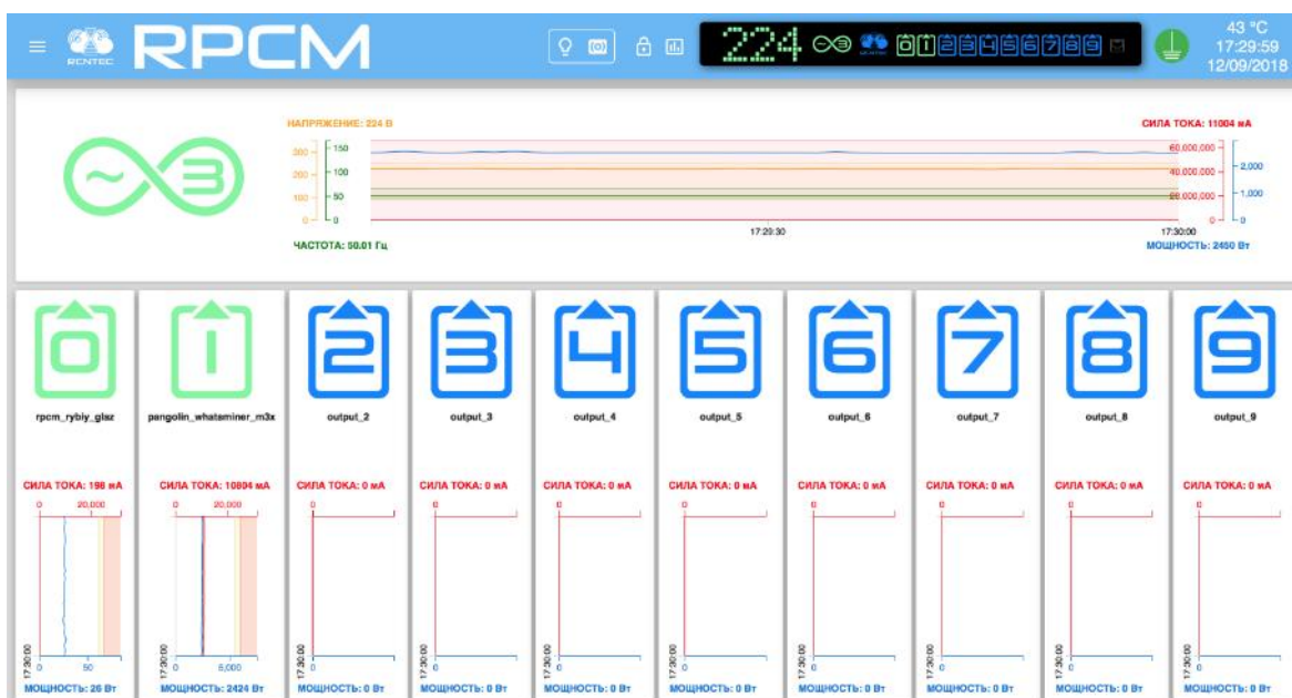
Рисунок 4.2.23. Панель управления Dashboard модуля RPCM 3x250 — "Режиме просмотра" (View Mode) с включенной функцией отображения текущих ограничений на графиках.
