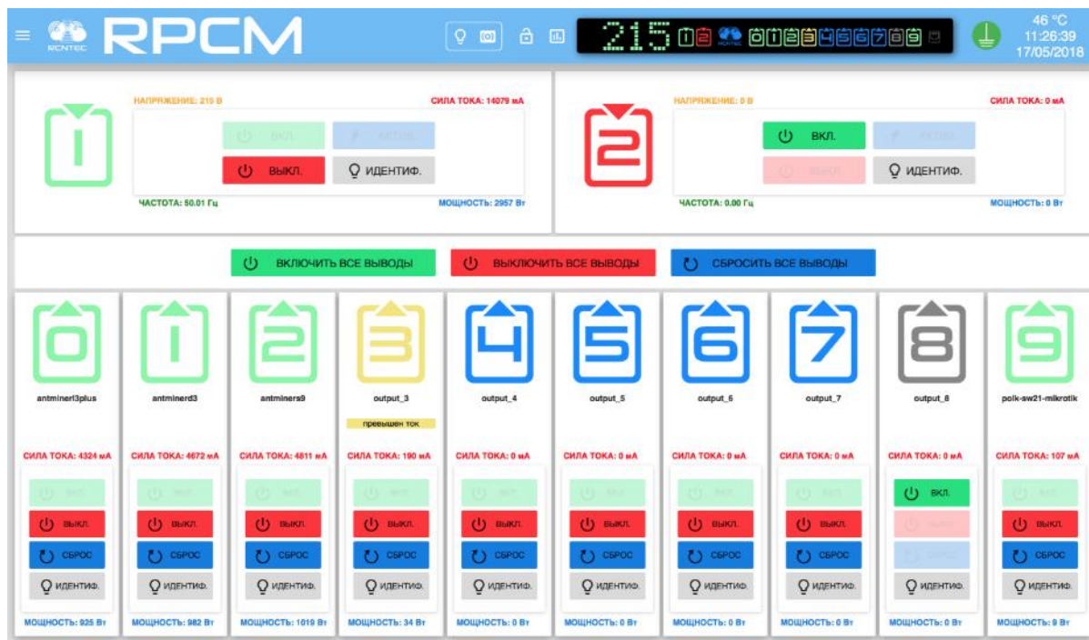
Рисунок 4.2.7. Панель управления web-интерфейса RPCM — Dashboard в режиме управления Control Mode моделей RPCM 1502 и RPCM 1532.
