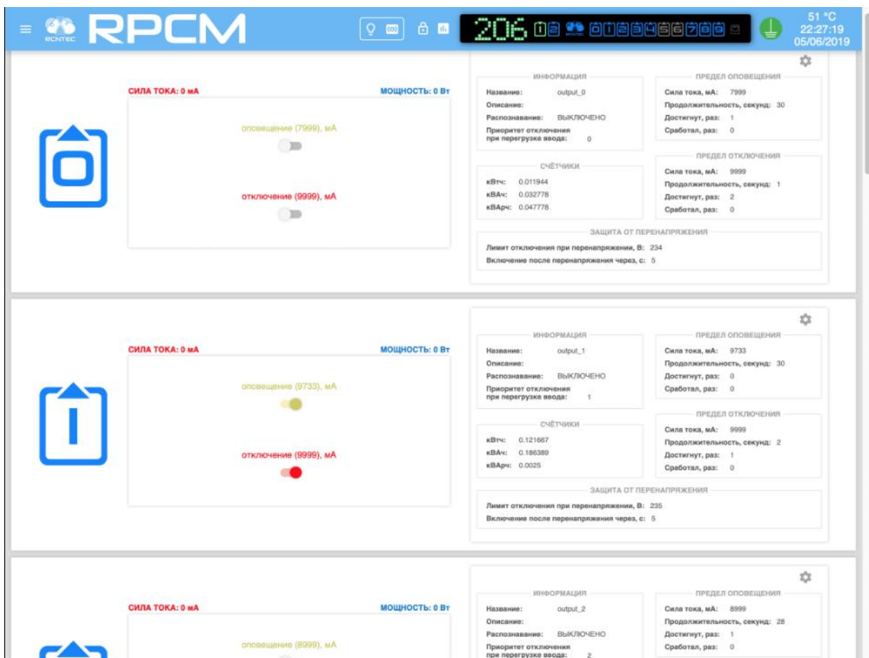
Рисунок 4.5.8. Установка отображения текущих ограничений для вывода 1.
