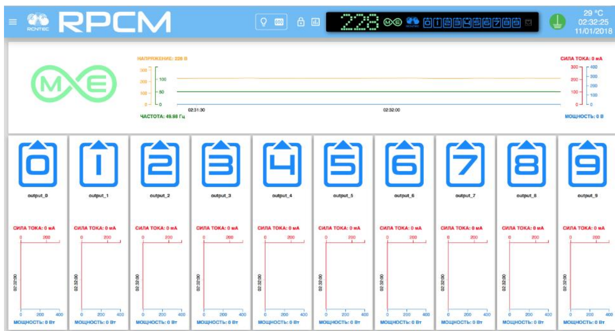
Рисунок 4.2.13. Панель управления Dashboard в режиме просмотра (View Mode) RPCM ME 1563.
